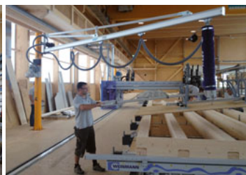
Der Säulenschwenkkrane verfügt über einen Schlauchheber.
