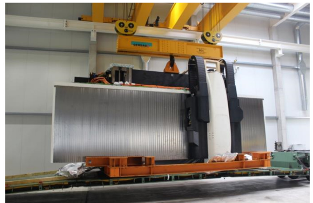
Mit angehängter Traverse und Tandembetrieb können Lasten bis 60 Tonnen transportiert werden
