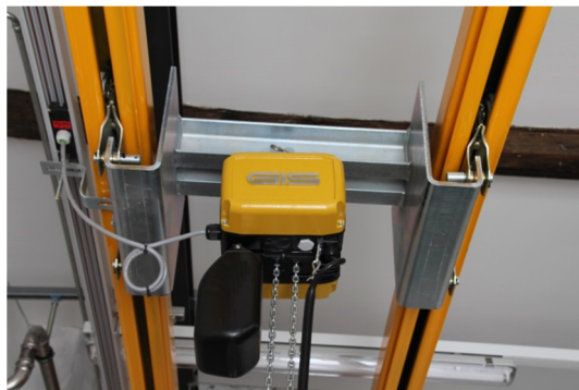
Zweiträger-Systemkran mit Zwischenbau (kurze Bauhöhe)
