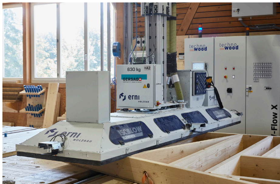
Automatisiertes Einblasen der Holzbau-elemente mit dem Karin-Stapelkran und der Dämmplatte.
