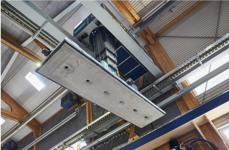
Karin-Stapelkran der Gersag Krantechnik AG mit der Einblasplatte.
