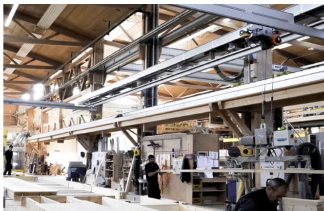
Auch schwere Hölzer lassen sich mit dem Gersag-Vakuumstabheber einfach positionieren
