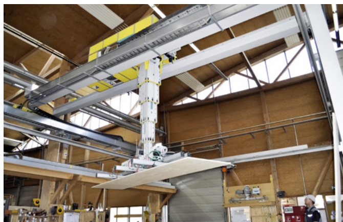
Ein Mitarbeiter platziert große Deckplatten mit dem Aluminiumstapelkran von Gersag
