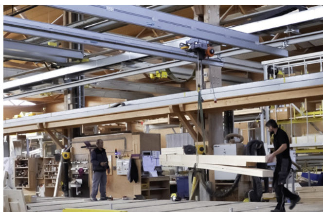
Einfaches Anordnen von Hölzern auf der Produktionslinie mit dem leichtgängigen Aluminium-Einträgerkran
