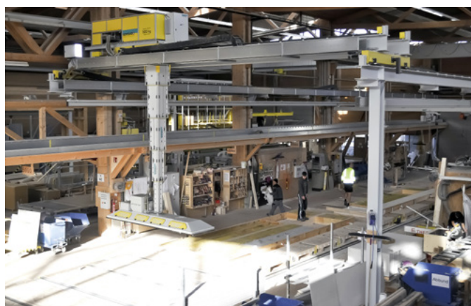
Der Karin-Stapelkran von Gersag ist Teil der Produktionslinie von Gump und Maier – im Bild mit der Einblasplatte
