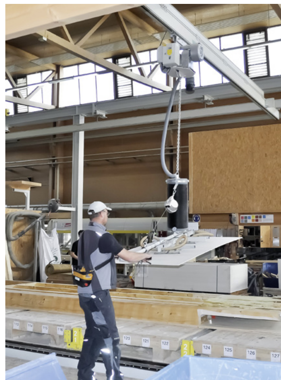
Angenehmes Positionieren der mittelgroßen Deckplatten mit dem Vakuumgerät des Aluminium-Einträgerkrans
