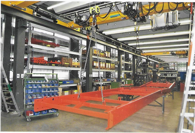
Kleinere Einträger Brückenkrane an den Arbeitsplätzen auf der ersten Ebene.
