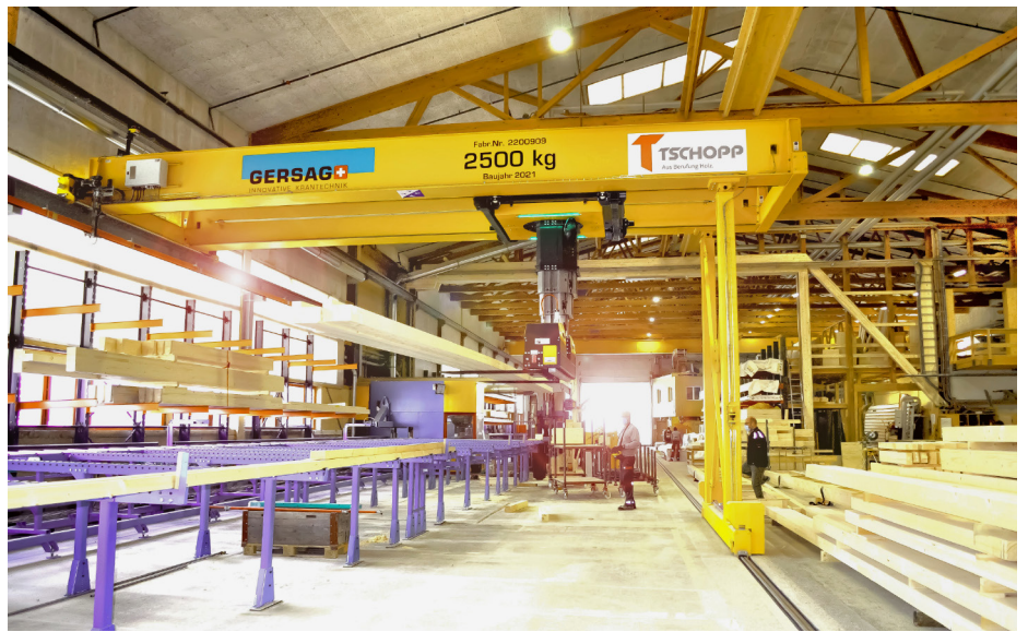
Der Stapelkran Gabriel kann Lasten von bis zu 2500 Kilo bewegen.
